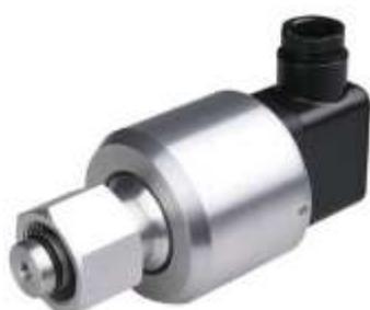
Диапазон измерения — от -0,1 до 1,0 МПа абс (настраиваемый). Точность — при 20°C: класс 1.0 и от -40°C до +60°C: класс 2.5. Степень защиты — IP65. Условия окружающей среды — от -40°C до +60°C, относительная влажность воздуха ≤95%RH. Скорость утечки —  $\leq 1 \times 10^{-9}$  Па\*м<sup>3</sup>/с (мониторинг герметичности гелия). Выходной сигнал — RS485. Протокол — ModBus RTU.
