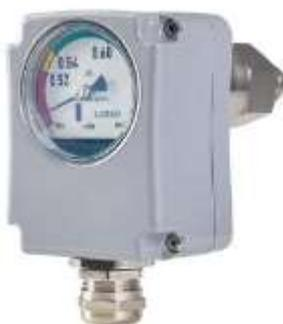
Диапазон измерения — от -0,1 до 0,9 МПа (настраиваемый). Точность —  $\pm 10$  кПа (от -30 до +50 °С. Степень защиты — IP65. Условия окружающей среды — от -40°С до +60°С, относительная влажность воздуха  $\leq 95\%RH$ . Скорость утечки —  $\leq 1 \times 10^{-9}$  Па·м<sup>3</sup>/с (мониторинг на утечку гелия). Способ подключения — радиальный или осевой. Тип контакта — микровыключатель.
