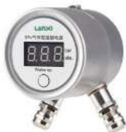
Диаметр корпуса — Ф64 мм. Диапазон измерения — 1.0 to 2бар abs. Точность — при 20°C: класс 1.0, 1.5 и от -30°C до +60°C: класс 2.5. Степень защиты — IP65. Условия окружающей среды — от -30°C до +60°C, относительная влажность воздуха ≤95%RH. Скорость утечки — ≤ 1 × 10<sup>-9</sup> Па·м<sup>3</sup>/с (мониторинг герметичности гелия). Способ подключения — радиальный или осевой. Тип контакта — электронный магнитный сигнальный контакт. Выходной сигнал — RS485.
