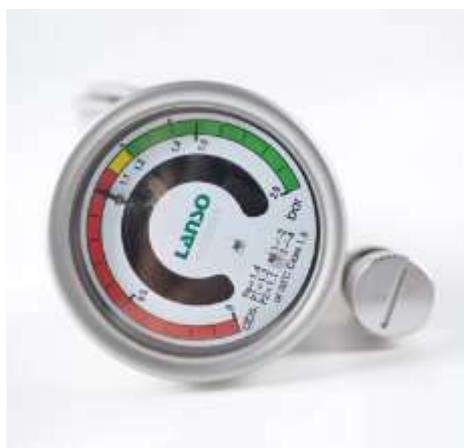
Диаметр корпуса — Ф64 мм. Диапазон измерения — От 0 до 2 бар (абс.) или от -1 до 6 бар. Точность — при 20°C: 1.5 и от -40°C до +60°C: класс 2.5. Степень защиты — IP65. Условия окружающей среды — от -40°C до +60°C, относительная влажность воздуха  $\leq 95\%RH$ . Способ подключения — радиальный или осевой. Тип контакта — магнитный переключатель с защелкой (максимум две группы, нормально открытые или нормально закрытые, настраивается на 3 группы в соответствии с потребностями пользователей).
