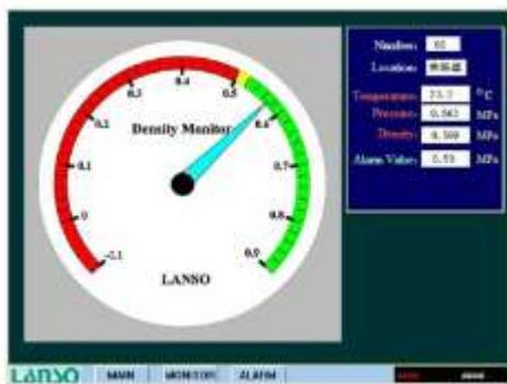
Система онлайн мониторинга плотности элегаза GDOMS представляет собой небольшую систему мониторинга с интервалами или станцию как единое целое, компактную и экономичную, отображающую в реальном времени температуру, давление, значение плотности в камерах SF6 внутри системы компактно и экономично.
